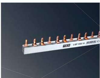
Barramentos de ponteira 16 mm 2 , <80A com isolamento em plástico auto-extinguível.
