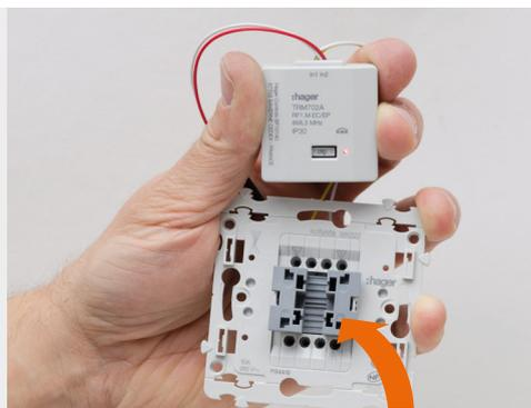
**01** Com o interruptor ou o botão de pressão ligado ao emissor, entrar no modo configuração pressionando brevemente o botão **cfg** e de seguida pressionar o botão de pressão ou bascular o interruptor ligado.
