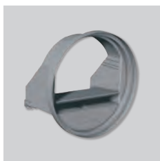
RD BP SM Reguladores de caudal autorregulables. Para instalar en el interior del manguito de las bocas BDOP. Diámetro 80 mm. Caudal: 15 ó 30 m 3 /h.
